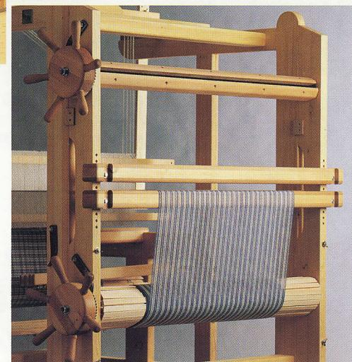
► Vävstolen kan vid vävning med varp av olika material utrustas med **dubbel varpbom**. Den har justerbar öppning och höjning av bommarna. Passar alla vävstolar.
